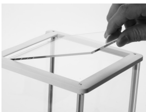
3) Install Top Door
